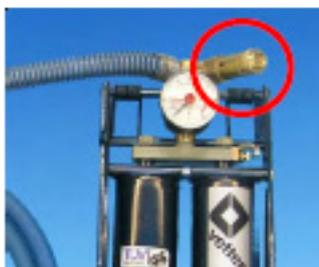
Ножной насос с предохранительным клапаном
