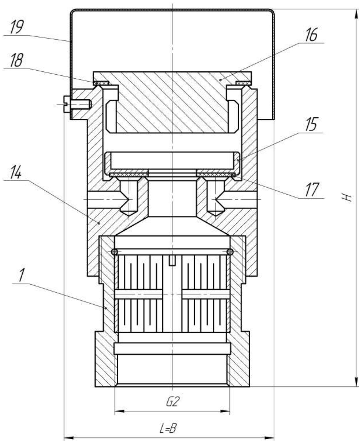
1 – предохранитель огневой, 14 – корпус, 15 – клапан вакуума,
