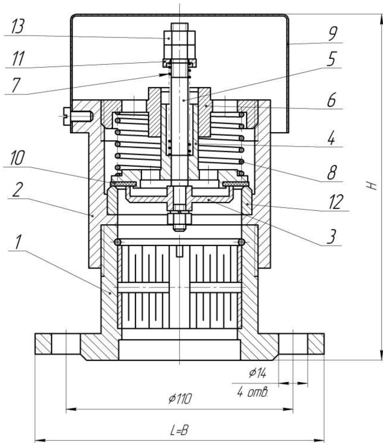
1 – предохранитель огневой, 2 – корпус, 3 – клапан вакуума, 4 – клапан давления,
